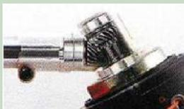
Надежность. Два опорных подшипника вала в редукторе.
