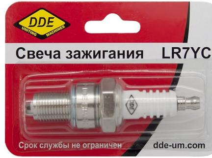
Свеча зажигания **DDE LR7YC** предназначена для использования в четырехтактных двигателях с верхним расположением клапанов, таких как HONDA серии GX и GP, модели 340-420, Briggs&Stratton и моторов аналогичных по конструкции LONCIN, DDE, Lifan, UO188 с объёмом цилиндра 340-450 см/куб. Возможная маркировка OHV или OHC.
