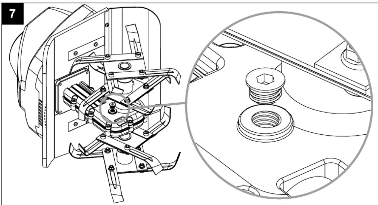
дренажный винт заливной горловины. В вертикальном положении культиватора уровень смазки должен быть вровень с нижним краем отверстия горловины. Добавьте масло, если уровень ниже. Закрутите винт. Проверяйте уровень масла как минимум два раза в течение сезона. Например, перед весенней и осенней эксплуатацией!
