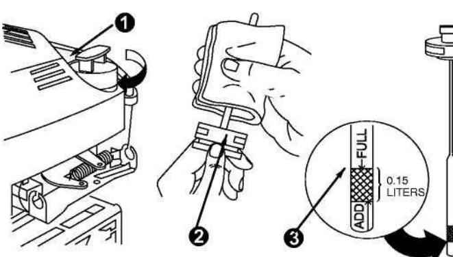
**рис. "Маслозаливная горловина (слева) и щуп-пробка (справа)"**
