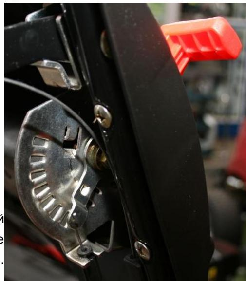
В результате деформаций струны при неправильной сборке газонокосилки или при грубой транспортировке **рычаг регулировки скорости** хода газонокосилки (см. Рис. 6) в положении минимум
