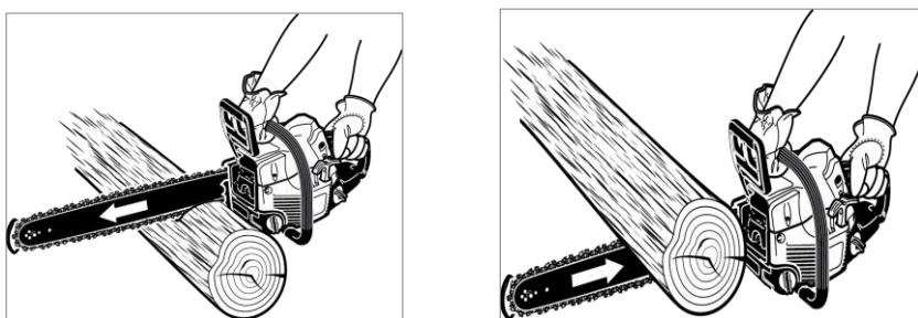
4. Оставьте мотор работать на полных оборотах в течение всего времени пилки.
