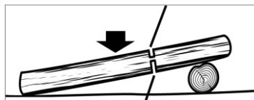
Во избежание защемления пильной шины и цепи внимательно следите за механическим напряжением бревна.
