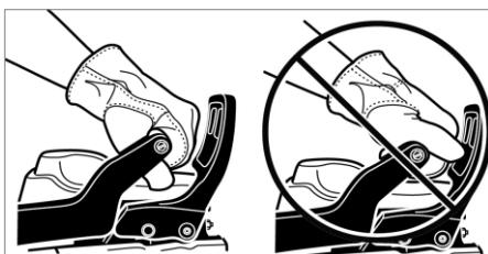
При работающем моторе держите пилу как можно крепче. Большой палец должен придерживать рукоятку снизу, а остальные пальцы — охватывать ее по окружности. Такой захват最难нее всего нарушить (в результате отбрасывания пилы назад или иной внезапной её реакции). Любой другой захват, при котором большой и остальные пальцы оказываются по одну сторону рукоятки, опасен, ибо чреват потерей управления пилой при малейшем ее отскоке.
