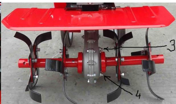
**Внимание:** Культиваторы с коробкой передач (V650II, V700II-DWN, V700II-H160W, V700II-DCWL4, V700II-H160WL4, V900II) поставляются без масла в редукторе. **Перед запуском заполнить редуктор трансмиссионным маслом!**
