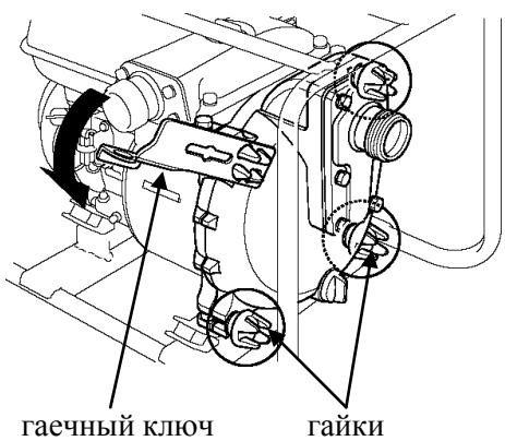
3. Снимите крышку насоса и выньте спиральную камеру из корпуса насоса. Очистите корпус насоса и спиральную камеру от возможной грязи.
