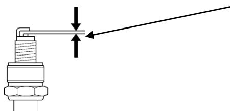
Д. Проверьте состояние уплотнительной шайбы свечи зажигания, и осторожно вверните свечу зажигания рукой, чтобы избежать повреждения резьбы.
