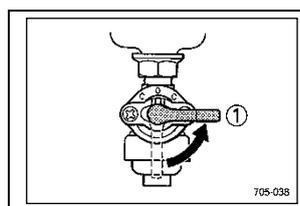
3. Поверните топливный кран в положение “OFF”.
