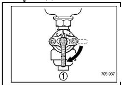
1. Поверните топливный кран в положение “ON”.
