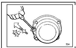
3. Заводите двигатель с помощью ручного стартера. Сначала тяните медленно за ручку стартера. Почувствовав небольшое сопротивление, Резко дерните.
