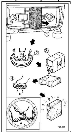
1. Снимите крышку воздушного фильтра, а затем сам фильтр.
