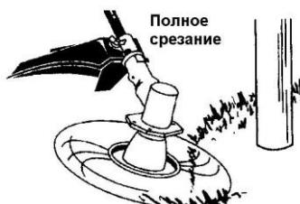
**КОШЕНИЕ** – С помощью бензокосы можно обработать труднодоступные участки газона, которые не под силу газонокосилке. При кошении удерживайте головку с леской параллельно поверхности земли. Не прижимайте головку к земле, так как это может повредить её.
