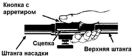
3. Крепко удерживая двигатель и верхнюю секцию штанги, вытащите насадку из сцепки.
