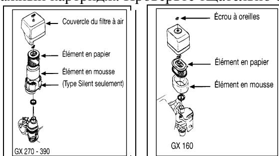
2. Промойте губку в бензине или моющем растворе. Вытрите ее чистой тряпкой. Промокните губку в чистом двигательном масле, затем выжмите ее, чтобы удалить излишки масла,
