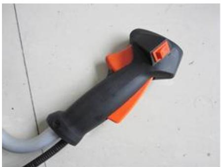
5. Вытянуть медленно пусковую ручку до первого заметного упора и после этого протянуть рывком и с усилием, повторить несколько раз, пока двигатель не «чихнет». Тросик стартера не вытягивать до упора.
