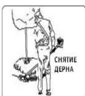
Для практически всех видов скашивания и резания, рекомендуется наклонять триммерную головку таким образом, чтобы обработанный материал был направлен ОТ работающего человека и защитного кожуха (см. соответствующий рисунок)
