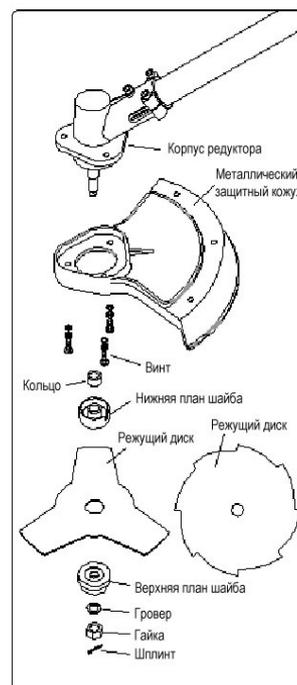
2. Плотно затяните винты тарированным гаечным ключом.
