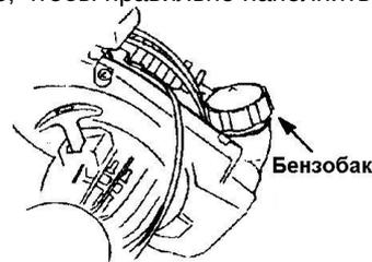
2. Снимите крышку бензобака, повернув её против часовой стрелки. Наполните бензобак до основания горловины.
