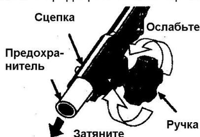
3. Выньте пробку из штанги дополнительной насадки (если имеется).
