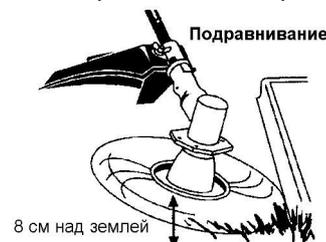
**ПОЛНОЕ СРЕЗАНИЕ** – Данный метод позволяет полностью удалить сорняки. В данном случае следует удерживать головку с леской на высоте 8 см над землей и под углом. При обработке поверхности около деревьев, столбов и т.д. леска должна ударяться о землю. Использование этого метода ведет к увеличению износа лески.
