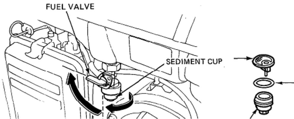
Каждые 100 часов работы чистите топливный фильтр отстойник.
