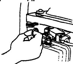
Примечание: Если двигатель запускается после короткого перерыва и он еще теплый, то рычаг должен оставаться в положении “ОТКРЫТО”.
