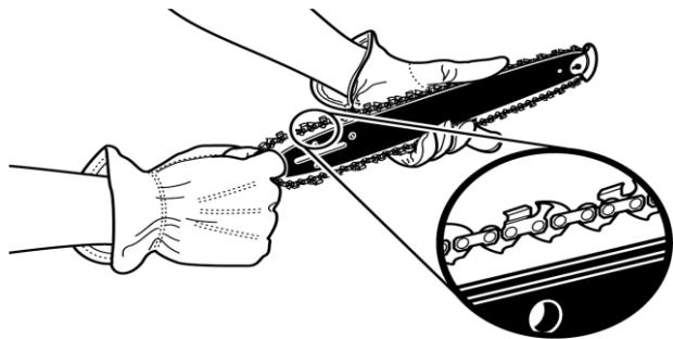
7. Установите крышку шины, проверяя что бы цепь не выпала из паза шины, следите за тем чтобы установленная под крышку скоба натяжителя была ориентирована зубцами согласно рисунку, что бы штифт натяжителя цепи не вышел из соответствующего отверстия на шине, далее наживите и закрутите, не затягивая тую, гайку крышки шины.
