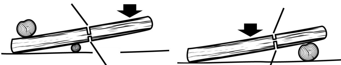
Во избежание защемления пильной шины и цепи внимательно следите за механическим напряжением бревна.
